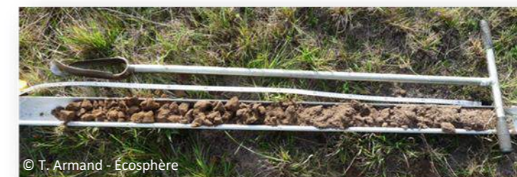
Sondage pédologique à la tarière manuelle
