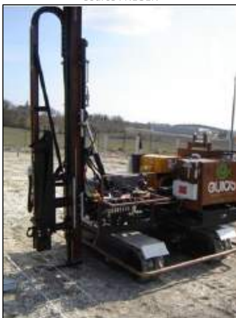
Illustration 48 : Engin de battage de pieux
